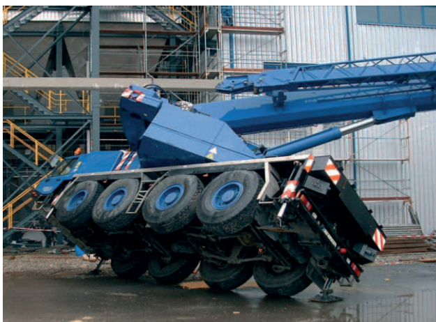
Auto-/Mobilkran: Plötzliche kurzzeitige Überlastung. Schadenhöhe: 28.000 EUR
