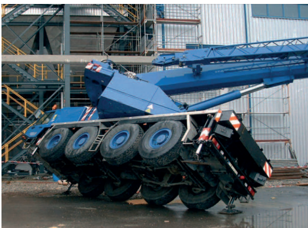
Auto-/Mobilkran: Plötzliche kurzzeitige Überlastung. Schadenhöhe: 28.000 EUR
